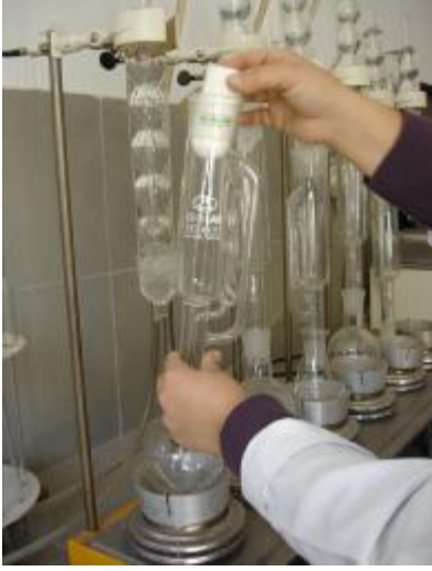
Resim 2.6: Kartuşu ekstraksiyon cihazına yerleştirme
