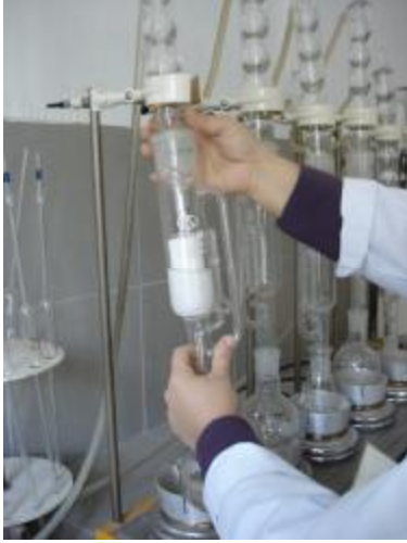
Resim 2.8: Ekstraksiyon cihazını ve balonu geri soğutucuya bağlama
